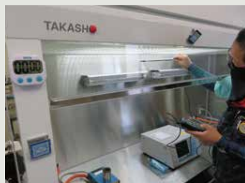
風速測定・清浄度測定
