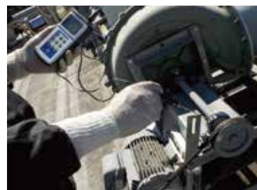
メンテナンス後測定 モーター：ベアリング温度/回転数/振動
