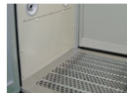
床吸込みグレーチング
